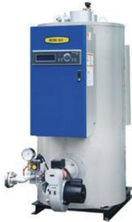
Современный водогрейный котел вертикального типа, оснащенный вакуум-системой, позволяющей доводить теплоноситель до температуры 88°C. Помимо встроенного теплообменника вторичного контура отопления в котлоагрегат интегрирован теплообменник вторичного контура горячего водоснабжения. То есть, этот котел может использоваться и для горячего водоснабжения жилых и промышленных помещений.
